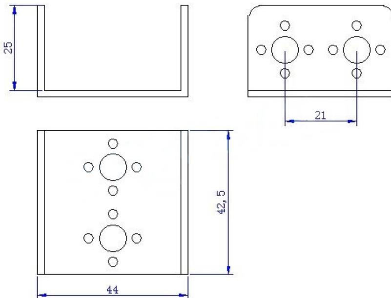
適合韓國的 HS322、HS422，輝盛的 MG995、MG996、SG5010 等舵機，支持 Hitec、Parallax、Futaba、輝盛等品牌（尺寸為 40x20x36mm 左右）標準舵機。
